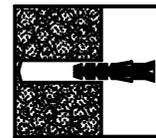
Beiliegendes Befestigungsmaterial eignet sich nur für Massivwände.
