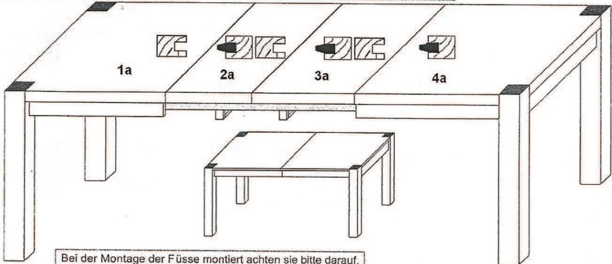
Bei der Montage der Füße montiert achten sie bitte darauf, dass die Füße aufgrund der Langlochbohrung in der Höhe verstellt werden können. Die Füße müssen nach Oben angehoben werden, damit sie eben zur Tischplatte sind.
