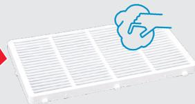
Filterabdeckung oben entfernen / reinigen
