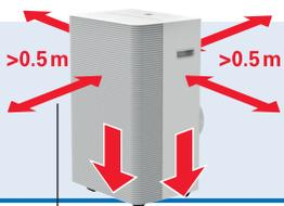
Gerät stabil auf ebener, trockener Unterlage hinstellen
