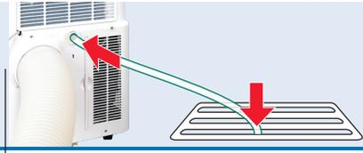
Bei Bedarf Kondenswasserschlauch anbringen
