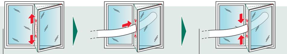
Reissverschluss öffnen, Schlauch ins Freie führen
