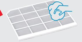
Unterer Filter herausziehen / reinigen
