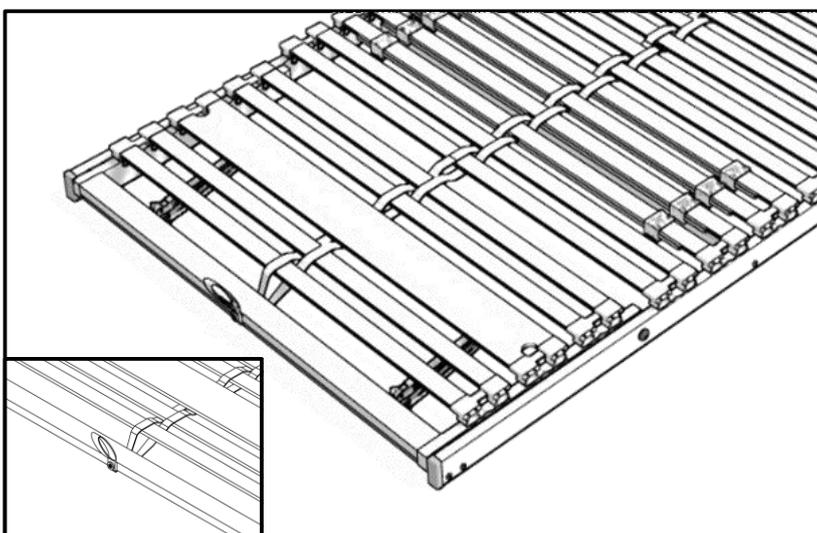
Drehen Sie das überstehende Ende zu einer Schlaufe. Legen Sie diese Schlaufe über das Anfangsstück. Am Kopf- und Fußteil befestigen Sie den Gurt mit je einer Schraube (C) und einer Scheibe (D).
