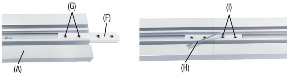
**Achtung:** Verbinden Sie zuerst die Profile mit den Profilverbindern und setzen Sie erst danach mit der weiteren Montage fort.
