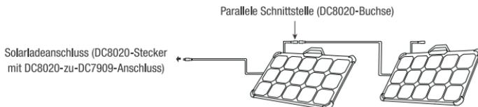
**Hinweis:** Sie können die Anzahl der Solarmodule in ihren eigenen Kombinationen entsprechend der Anzahl der gekauften Solarmodule eingeben. Derzeit werden 1, 2, 3, 4, 5, 6, 8 und 12 Jackery SolarSaga 80 Solarmodule beim Laden unterstützt.
