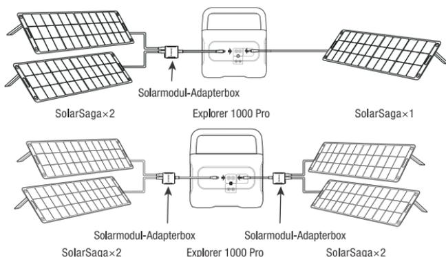
**Hinweis:** Der Jackery Explorer 1000 Pro unterstützt derzeit keine drei 100W- oder 200W-Solarmodule in Reihe an einem Eingang, sonst löst er einen Überspannungsschutz aus.
