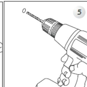
Bohren Sie die mit einem 6mm Stein-Bohrer die die Bohrlöcher
