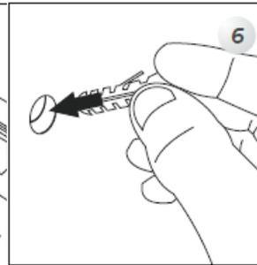
Setzen Sie die mitgelieferten Dübel in die Bohrlöcher
