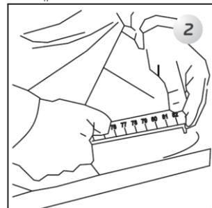
Übertragen Sie das Maß auf die Laufschiene und kürzen Sie diese dementsprechend mit einer Metall-Hand-Säge
