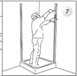
Befestigen Sie die beiden seitlichen Anschlagprofile
