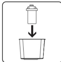
**4.** Setzen Sie den Filter in den Filterbehälter ein, sodass er fest sitzt. Ziehen Sie ihn dafür mit einer leichten Drehbewegung und etwas Druck nach unten.
