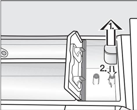
1. Saugheber aus der Kammer
