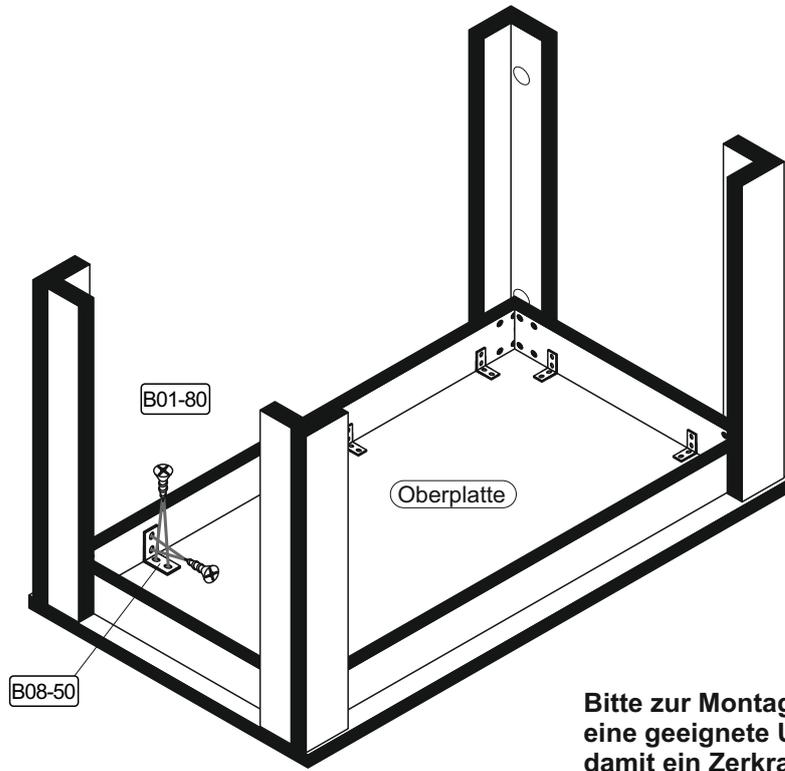
Bitte zur Montage des Tisches eine geeignete Unterlage verwenden, damit ein Zerkratzen der Oberplatte ausgeschlossen werden kann!
